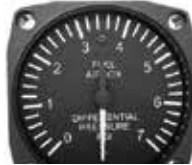
2-1/4 inch UMA Fuel Airbox Pressure Case: Valox 420 Plastic Weight: 4.8 oz.
